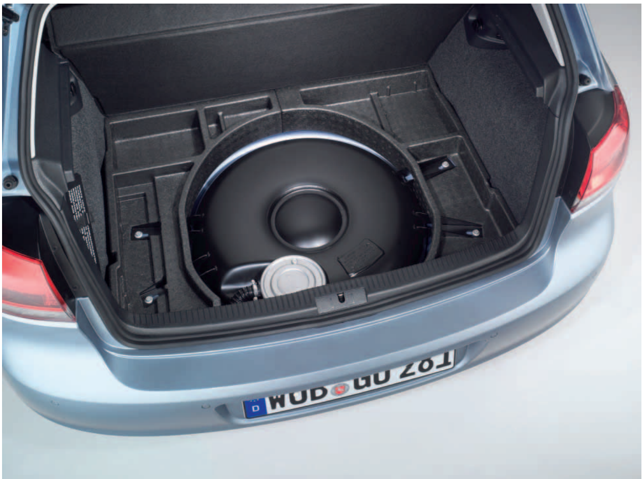
Abb.: Autogastank in der Reserveradmulde unter dem Ladeboden im Kofferraum
