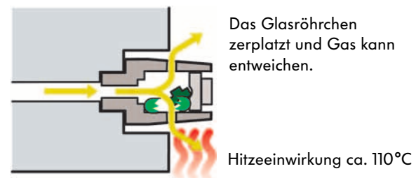
Abb.: Funktion der Thermosicherung
