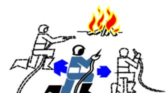
Rohrführer muss sich bewegen, damit er alle Bereiche erfasst Löschmitteleinsatz systematisch einsetzen
