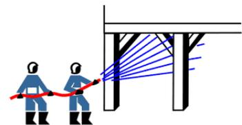
Primär tragende Teile kühlen (Achtung bei Stahlkonstruktionen)
