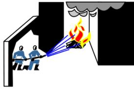
Ausnutzung von Schutz- und Deckungs-Möglichkeiten. Standort einnehmen unter tragenden Teilen, hinter Wänden
