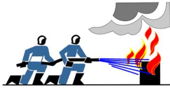
Unterstützung schützt den Rohrführer, löst ihn ab, Rückweg sichern, Schlauchvorrat, Verbindung, nötig mit Seil sichern
